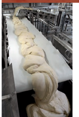
Vom Ruheband gleitet der vorgegarte Teig sanft in den Portioniertrichter.
